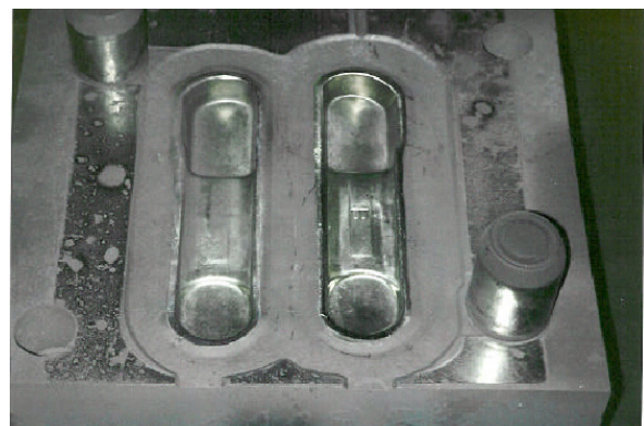
Matryca kuźnicza zabezpieczona elektrodą XHD-6865 i obrabiona elektroiskrowo po wykonaniu 2500 odkuwek ciągle w doskonałym stanie.
